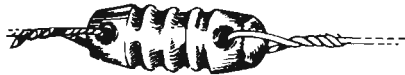
Fig. 14 - Gli Isolatori sono elementi che assumono grande importanza nell'installazione delle antenne, perché contribuiscono ad elevarne l'efficienza. Quelli in figura sono di ottima qualità.
